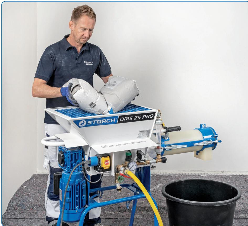
Schutzgitter mit zusätzlichen Zacken zum einfachen Aufreißen der Säcke und zur schnellen Entleerung.
