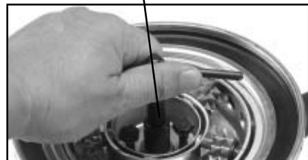
Allentare la vite di serraggio media
