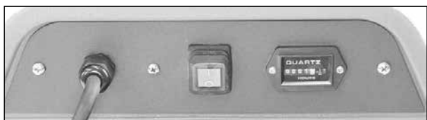
Il contatore delle ore di esercizio indica le ore di esercizio passate.
