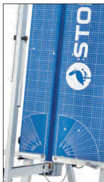
Goed afleesbare meetschaal om rationeel te snijden en herhalingen vlot uit te voeren
