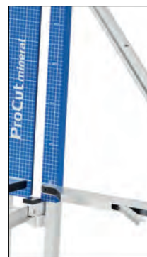
Plaatsteun voor het vastzetten van dikkere isolatieplaten
