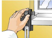
3. Festlegung der Überlappung zwischen Fensterbankoberkante und Dämmmaterial
