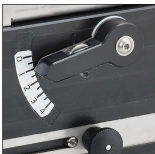
Präzise Einstellung des Kleisterauftrags
