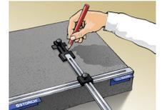
4. Übertragung der Maße auf die Dämmplatte
