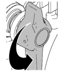
Klep geopend (Ontluchting en drukontlasting)
