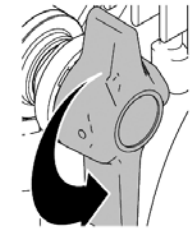
Ventil otevřený (odvzdušnění a tlakové odlehčení)
