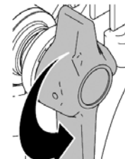
Ventil otevřený (odvzdušnění a tlakové odlehčení)
