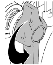
Ventil otevřený (odvzdušnění a tlakové odlehčení)
